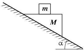
11. На наклонной плоскости, образующей угол  $\alpha$  с горизонтом, находится клин массы  $M$ . На верхнюю (горизонтальную) поверхность клина помещен брускок массы  $m$ . Найдите ускорения, с которыми будут двигаться брускок и клин. Трение между всеми соприкасающимися поверхностями отсутствует.
