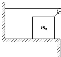
13\*. К свободному концу нити, прикрепленной к стенке и переброшенной через ролик, подвешен груз. Ролик закреплен на бруске массы  $m_0$ , который может скользить по горизонтальной плоскости без трения. В начальный момент нить с грузом отклоняют от вертикали на угол  $\alpha$  и затем отпускают. Найдите ускорение бруска, если угол, образованный нитью с вертикалью, не меняется при движении системы. Чему равна масса груза?
