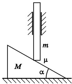
9. Клин массы  $M$  с углом  $\alpha$  при вершине лежит на горизонтальном столе. На него опирается вертикальный стержень массы  $m$ , пропущенный через втулку, которая не дает ему поворачиваться, но позволяет свободно двигаться в вертикальном направлении. Под собственным весом стержень опускается, заставляя клин скользить по плоскости. Найдите ускорения стержня и клина. Коэффициент трения стержня о клин равен  $\mu$ . Трение между столом и клином отсутствует.
