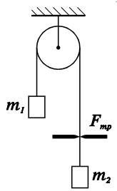
7. Нить, перекинутая через неподвижный блок, пропущена через щель. На концах нити подвешены грузы, масса которых  $m_1$  и  $m_2$ . Найдите ускорения грузов, если при движении нити на нее со стороны щели действует постоянная сила трения  $F_{tp}$ .
