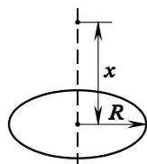
4. Электрический заряд  $Q$  равномерно распределен по тонкому кольцу радиуса  $R$ . Найдите потенциал электрического поля, создаваемого этим зарядом в точке, лежащей на оси кольца на расстоянии  $x$  от его центра.
